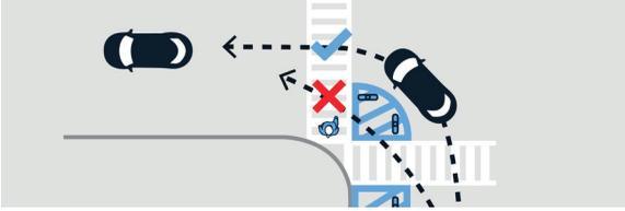
Una cuña para giro lento es una combinación de marcas en el pavimento, bolardos flexibles y bordillos o montículos de caucho o plástico. Reducen a velocidades más seguras a los choferes que doblan.
